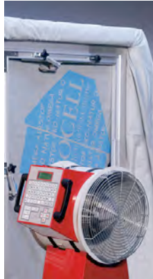
BlowerDoor-Messungen zeigen Undichtheiten in der Gebäudehülle schnell und eindrucksvoll auf.
